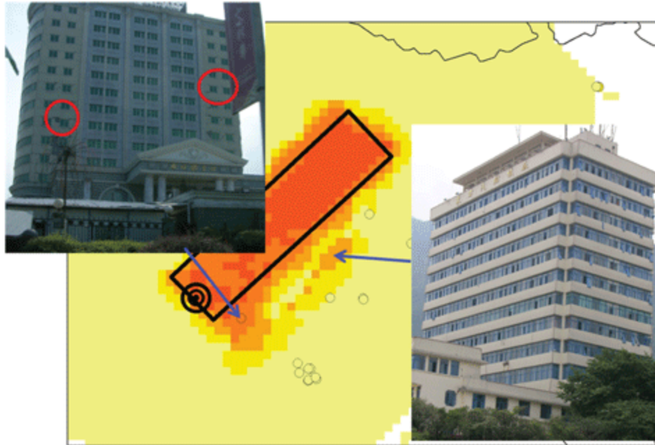
图六：高层钢筋混凝土剪力墙结构损失率的模型预测值和观察值比较。背景色彩是预测值，小圆圈是观察值。来源：AIR 环球。
